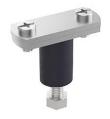
Support métallique pour conducteur plat de 30x2mm, avec vis et isolant en PVC pour revêtement imperméable. Fabriqué en acier inoxydable.
