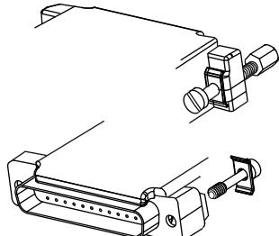
Fig3.: Disposición de tornillería para equipos con puerto D-SUB25 hembra / Disposition of the screws for the equipments with female parallel port D-SUB25.
