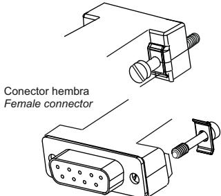
Fig3.: Disposición de tornillería para equipos con puerto D-SUB9 hembra / Disposition of the screws for the equipments with female parallel port D-SUB9.
