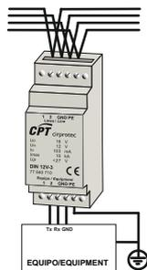
Fig3. Conexión de un sistema punto a punto / Device connection for one to one system.
